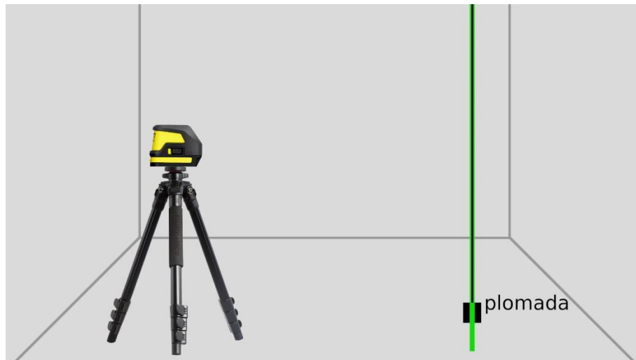
Línea vertical sin desviación, bien ajustada
