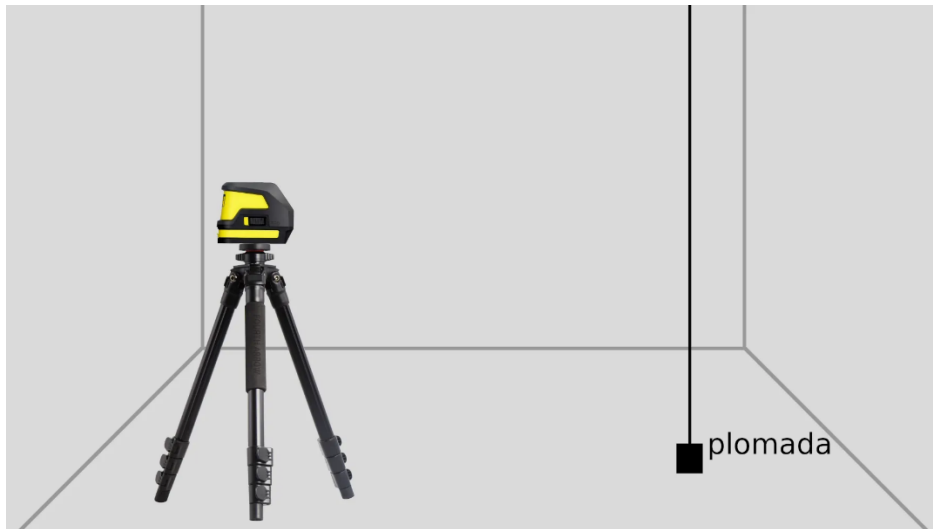
Paso 1: línea vertical de referencia usando una plomada de obra
